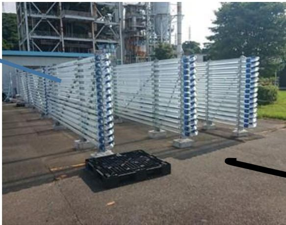
【図】 大規模クローズ型培養装置 (1.5m<sup>3</sup>/基)
