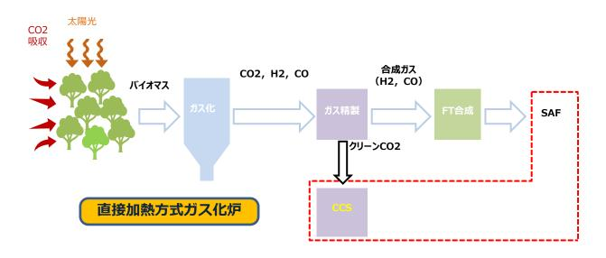
国産ガス化炉の固有技術(直接加熱方式)とCCSを組み合わせることにより、森林が吸収したCO2をネガティブとして、SAFのLCAに反映できている。
