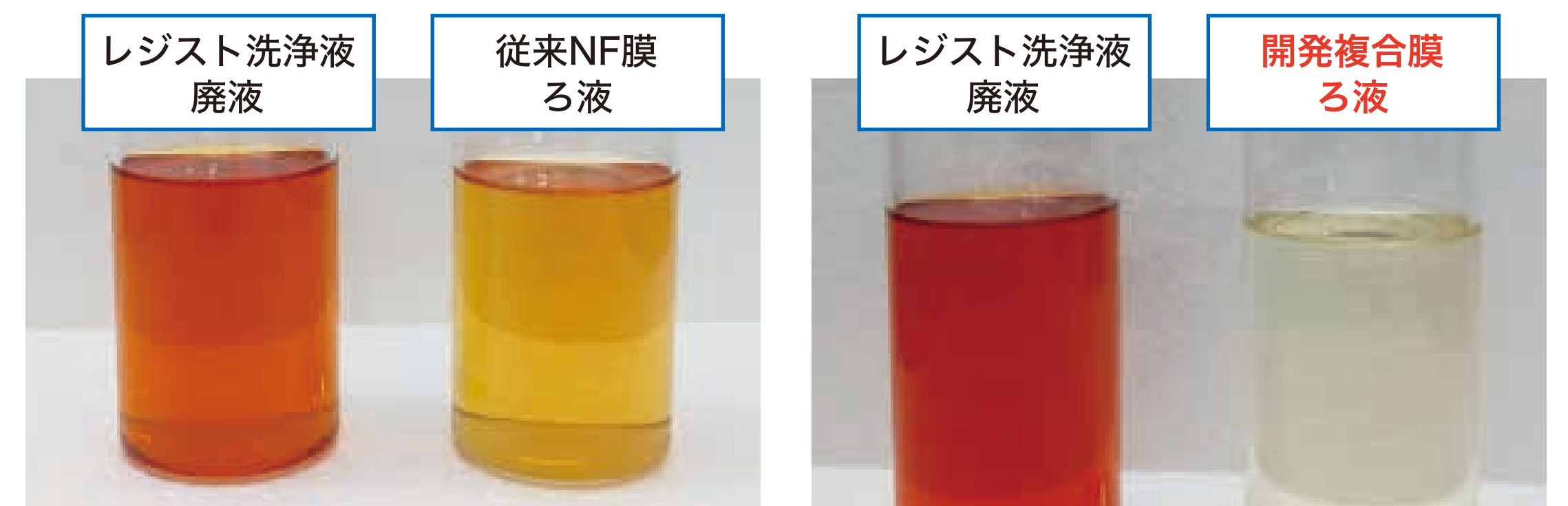
レジスト洗浄液廃液阻止試験
