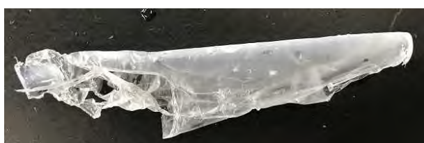
図 ①-16 酸素共存後に生成した HFO-1123 重合物
