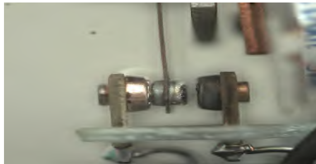
図②. 1. 3-5 アーク放電後の接点表面の様子
