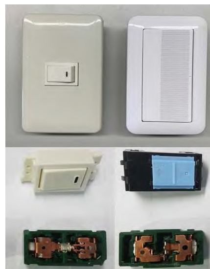
図②. 2. 1-1 供試照明スイッチの外観写真。 上段：スイッチ筐体、中下段：接点部 左列：Type A、右列：Type B
