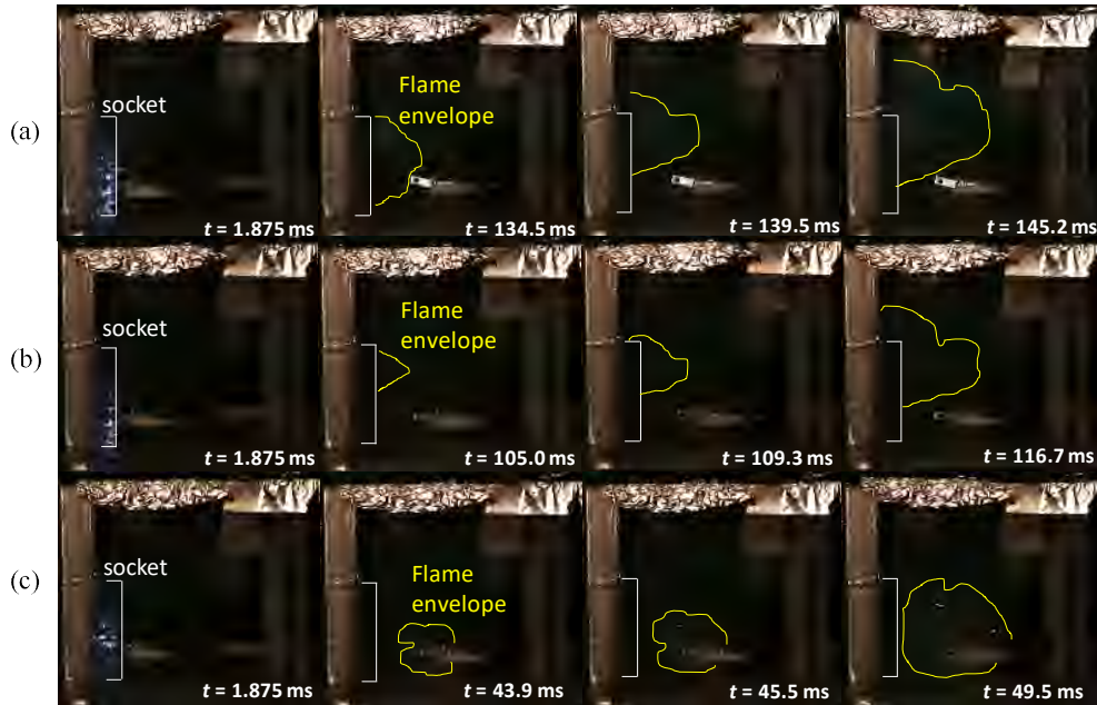
図②. 3. 4-2 コンセント抜き差しによるプロパン／空気混合気の着火挙動
