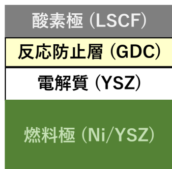
SOFC単セルの構成略図
