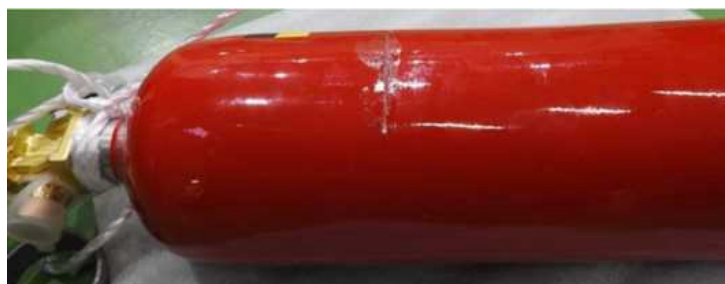
図 2. 1. 1. 7-259 7. 7m/s アングル衝撃試験後写 2（衝撃部位）
