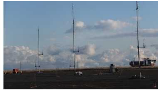
3次元風速計設置状況
