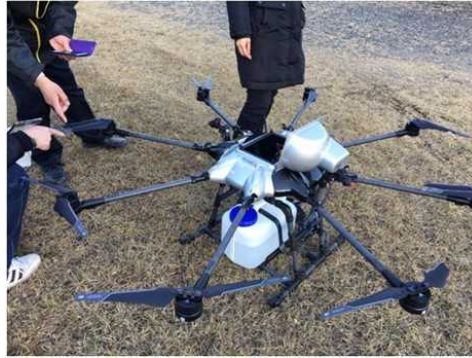
図 2.1.1.7-215 垂直落下試験で プロペラが破損した X-F1
