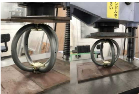
図 2.1.1.7-373 ダブルリング部品B縦の強度試験の様子と降伏塑性変形後の形状
