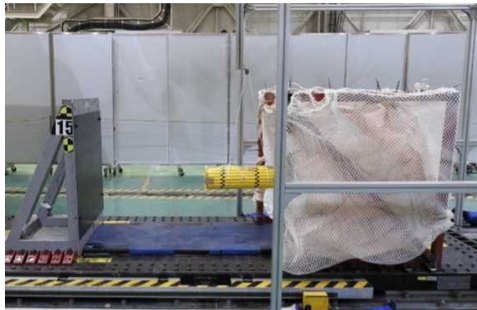
図 2. 1. 1. 7-310 18m/s 垂直 (バルブ) 衝撃試験前写真
