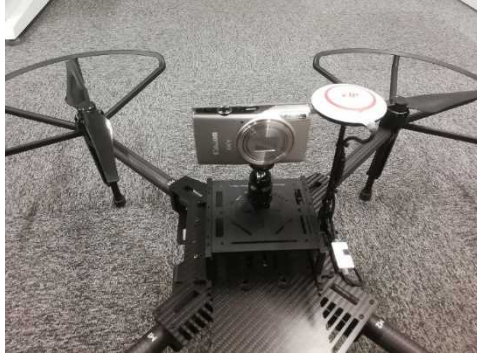
図 2.1.1.2-14 カメラ水平方向設置
