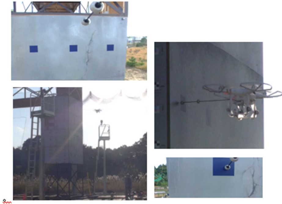
図 2.1.1.2-87 小型機による打音データ取得動作の例
