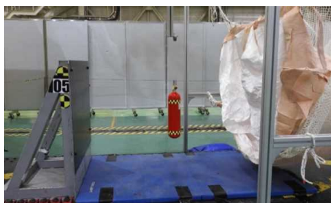
図 2. 1. 1. 7-253 7. 7m/s 水平衝撃 試験前写真
