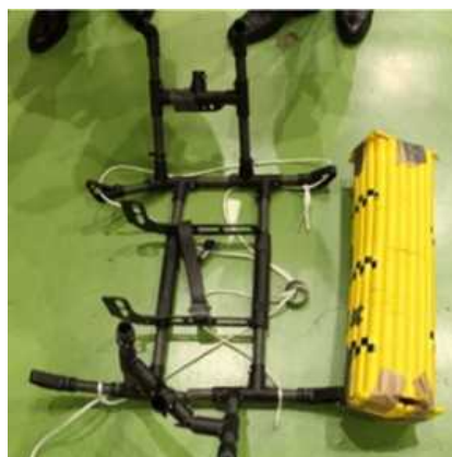
図 2.1.1.7-334 18m/s 衝撃試験後 写真 2（ドローン②）
