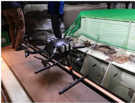
図 2.1.1.7-153 落下終端速度・ 姿勢観測試験供試体準備 (PF-2 水平プロペラフリー)
