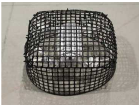
図 2.1.1.7-92 ガード付きの 無人航空機 (200g ドローン例 1)
