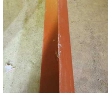
図 2.1.1.7-242 アングル落下試験後 写真 2 (試験後のアングル)
