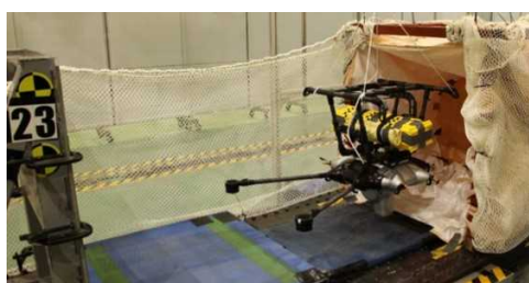
図 2.1.1.7-331 18m/s 衝撃試験前 写真 1（ドローン②）
