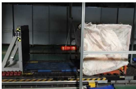
図 2.1.1.7-264 18m/s 垂直衝撃試験前写真 （容器①）
