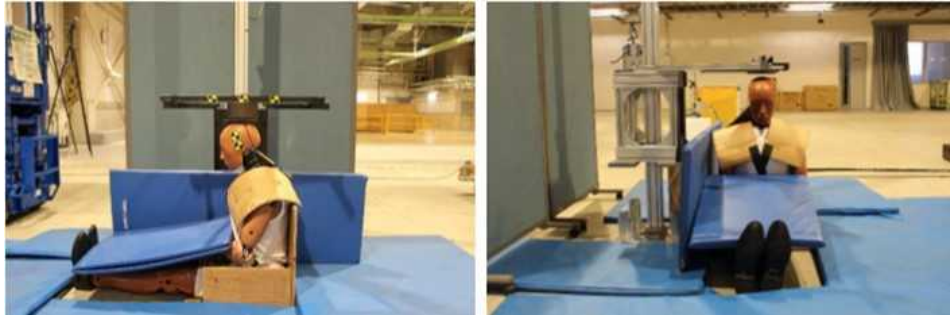
図 2.1.1.7-64 ダミーの設置状況
