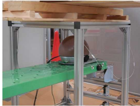
図 2.1.1.7-72 ヘッドインパクトの設置状況
