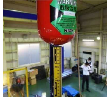
図 2.1.1.7-225 垂直落下試験前写真 1 (高さ 3m 確認)
