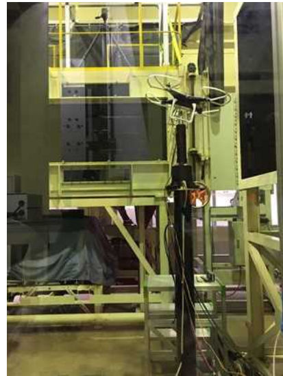
Phantom3 ダミー機で傾斜角を変えた状態
