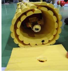
図 2.1.1.7-313 18m/s 垂直 (バルブ) 衝撃試験後写真 3
