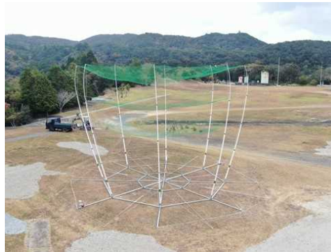
図 2. 1. 1. 7-340 落下受止装置を使用した落下試験による落下終端速度測定
