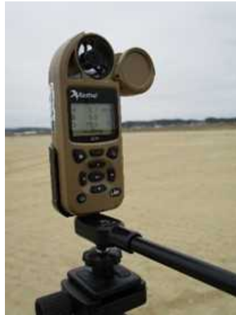
図 2. 1. 1. 7-18 Kestrel 風速・風向・温度・湿度計設置風景
