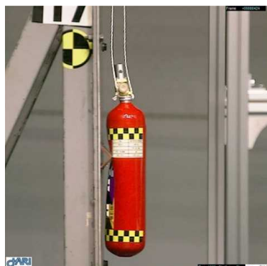
図 2. 1. 1. 7-274 18m/s アングル衝撃試験 高度カメラ写真（容器①、最大変形時）
