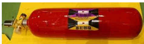
図 2.1.1.7-327 18m/s 衝撃試験後 写真 9 (ドローン①)
