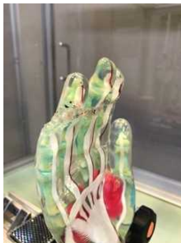
図 2.1.1.7-120 手指ダミーの損傷（検証試験結果）
