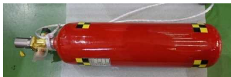
図 2. 1. 1. 7-269 18m/s 水平衝撃試験後 写真 2 (容器②)
