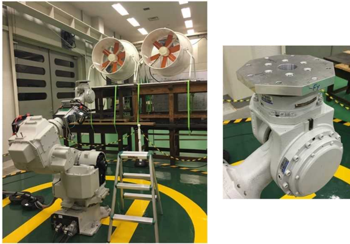
図 2.1.1.7-142 試験装置とロードセル拡大図
