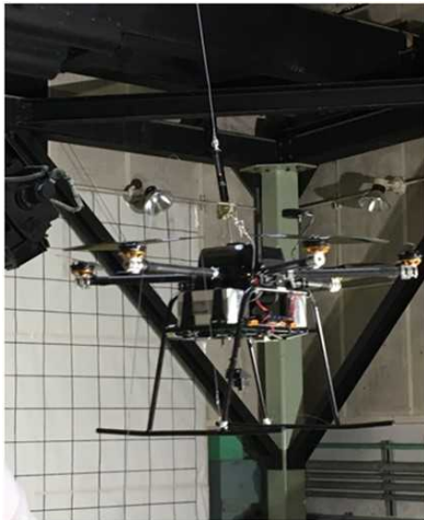
図 2.1.1.7-151 落下終端速度・ 姿勢観測試験 (PF-1 水平プロペラフリー)
