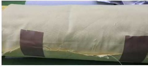
図 2.1.1.7-299 18m/s アングル衝撃 試験後写真 3 (保護付容器①)
