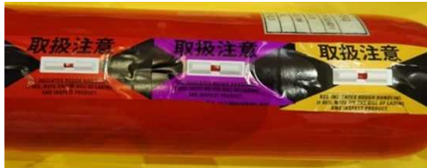
図 2. 1. 1. 7-290 18m/s 水平衝撃試験後 写真 5（保護付容器①）
