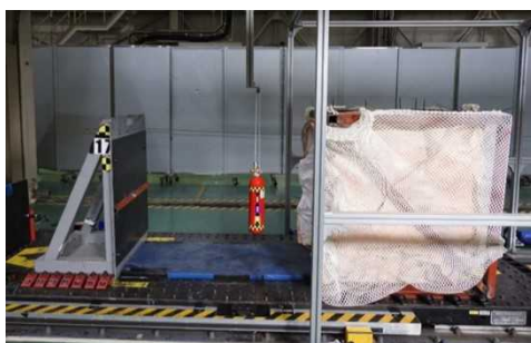
図 2. 1. 1. 7-271 18m/s アングル衝撃試験前写真（容器①）
