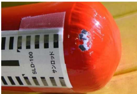
図 2.1.1.7-228 垂直落下試験後写真 3 (落下衝撃部位 2)
