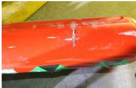
図 2.1.1.7-243 アングル落下試験後写真 3 (落下衝撃部位)
