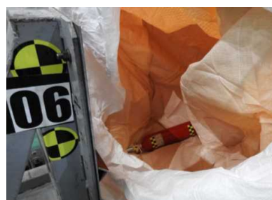
図 2. 1. 1. 7-258 7. 7m/s アングル衝撃 試験後写真 1（全体）
