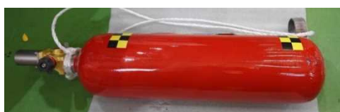
図 2. 1. 1. 7-268 18m/s 水平衝撃試験後 写真 1 (容器①)
