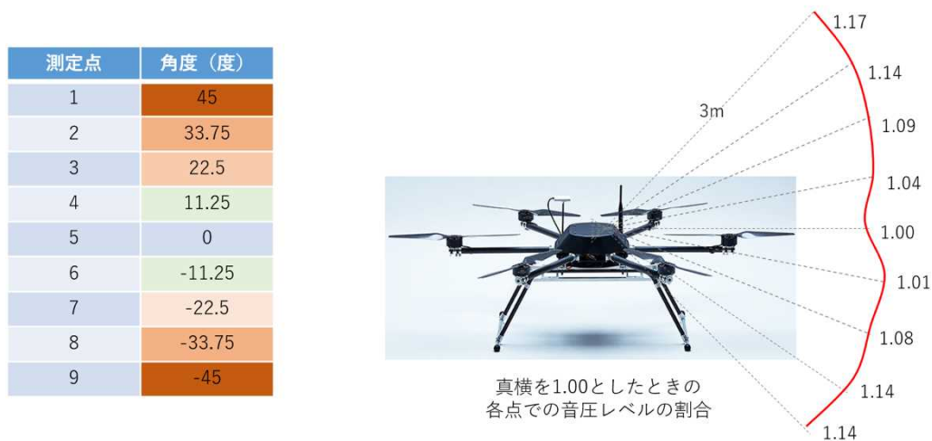
図 2.1.1.1-10 音圧を測定した点とそれぞれの点での音圧レベルの比較
