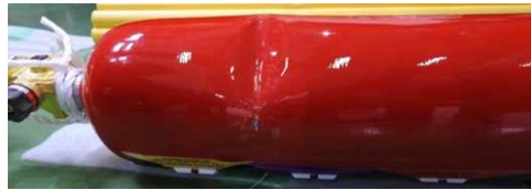
図 2.1.1.7-301 18m/s アングル衝撃試験後写真 5 (保護付容器①)
