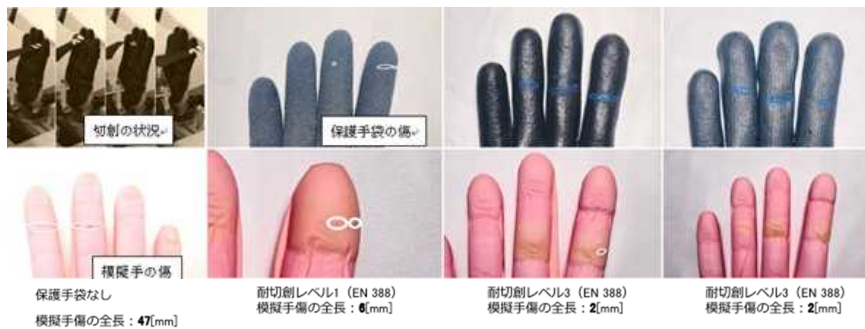
図 2.1.1.7-112 9[inch]のプロペラ（プラスチック製、ストレート）による切創
