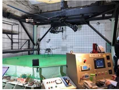
垂直風洞試験による空力抗 力と重力との平衡風速計測
