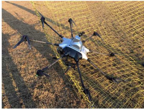
図 2. 1. 1. 7-392 水平飛行からの落下試験で、受止装置で受け止められたが、ネット上の落下位置が低すぎたため、地面に衝突して破損した X-F1
