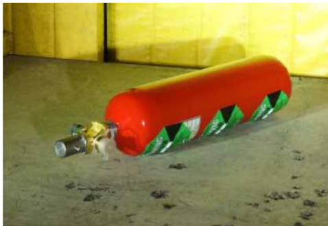
図 2.1.1.7-226 垂直落下試験後写真 1 (全体)
