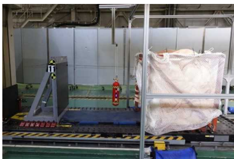
図 2. 1. 1. 7-267 18m/s 水平衝撃試験前写真 (容器①)
