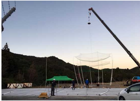
図 2.1.1.7-203 支柱の静荷重試験場 図 2.1.1.7-204 支柱の静荷重試験場 (赤いチョークのラインまで支柱が曲がる)
