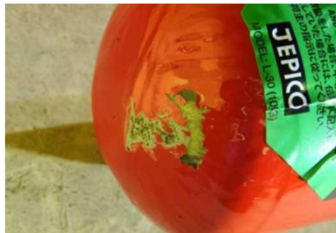
図 2.1.1.7-227 垂直落下試験後写真 2 (落下衝撃部位 1)
