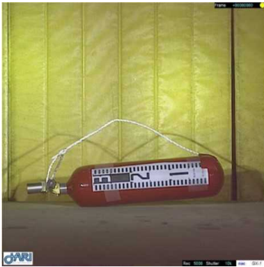
図 2.1.1.7-237 水平落下試験高度カメラ写真1 (コンクリート接触時)
