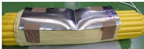
図 2. 1. 1. 7-298 18m/s アングル衝撃 試験後写真 2 (保護付容器①)
