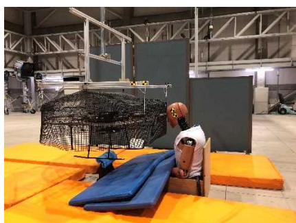
図 2.1.1.7-82 ガード付き 無人航空機の設置状況
