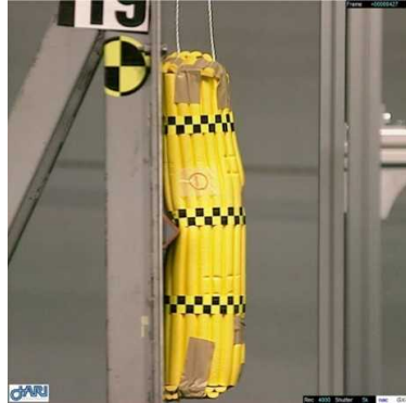
図 2. 1. 1. 7-309 18m/s アングル衝撃試験高度カメラ写真 (保護付容器①、最大変形時)
