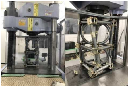
図 2.1.1.7-369 ユニットA縦の強度試験の様子と降伏塑性変形後の形状
