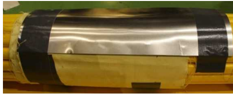
図 2.1.1.7-336 18m/s 衝撃試験後 写真 4 (ドローン②)
