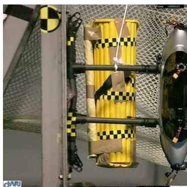
図 2.1.1.7-328 18m/s 衝撃試験 高度カメラ写真 (足接触時)
