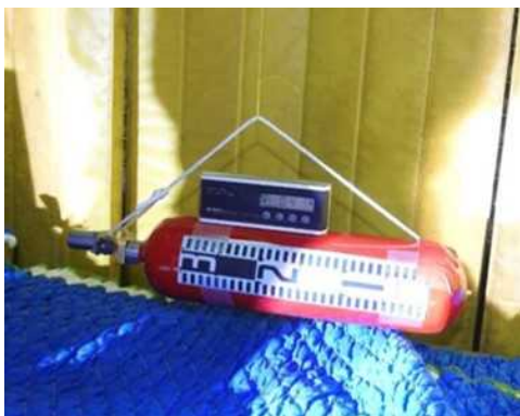
図 2.1.1.7-232 水平落下試験前写真 1 (水平確認)
