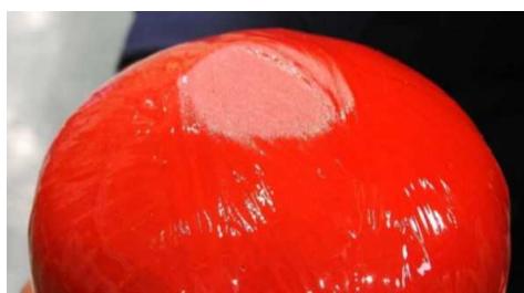
図 2.1.1.7-251 7.7m/s 垂直衝撃試験後写真 2 （衝撃部位）
