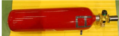
図 2.1.1.7-337 18m/s 衝撃試験後写真 5 (ドローン②)
