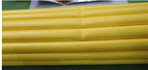
図 2.1.1.7-300 18m/s アングル衝撃 試験後写真 4 (保護付容器①)
