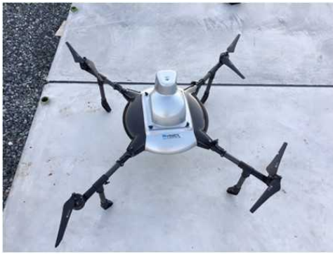
図 2.1.1.7-387 試験でプロペラが 破損した X-S1
