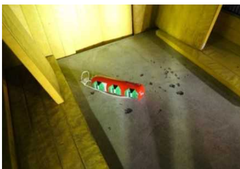
図 2.1.1.7-234 水平落下試験後写真 1 (全体)
