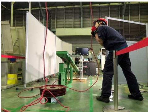
図 2.1.1.7-50 重りを落下させる様子
