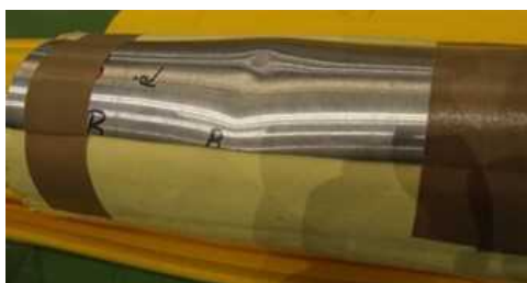
図 2.1.1.7-324 18m/s 衝撃試験後 写真 6 (ドローン①)
