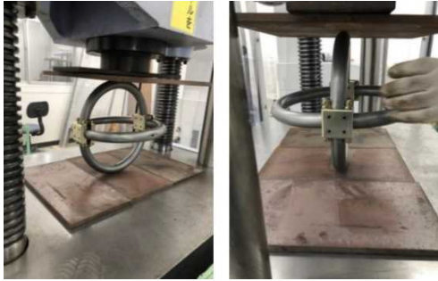
図 2.1.1.7-375 ダブルリング部品 B 横の強度試験の様子と降伏塑性変形 後の形状
