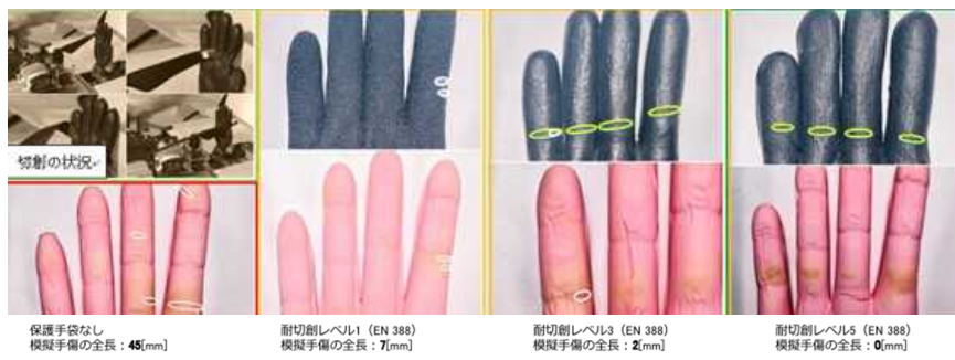
図 2.1.1.7-113 15[inch]のプロペラ（プラスチック製、ストレート）による切創
