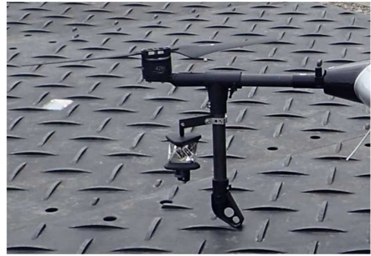
図 2. 1. 1. 2-19 ATP2S 設置〈大型機〉2
