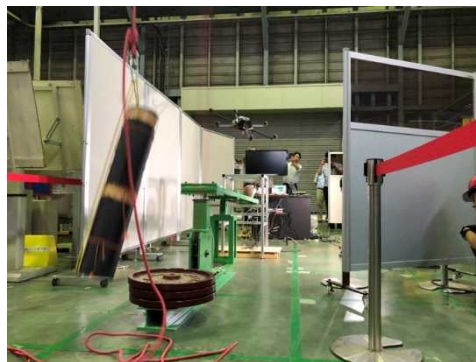
図 2.1.1.7-51 重り落下直後、ヘッドインパクトが無人機に下から衝突し、無人機も飛び上がっている様子
