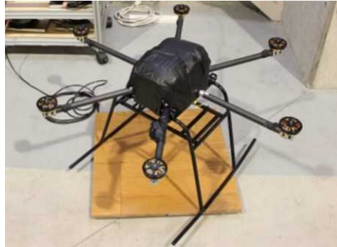
図 2.1.1.7-76 7.6kg に調整した無人航空機無人航空機 (PF-1)
