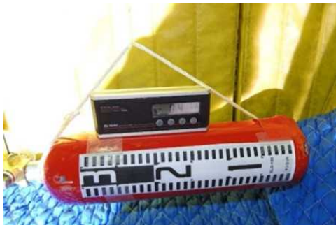
図 2.1.1.7-239 アングル落下試験前写真1 (水平確認)
