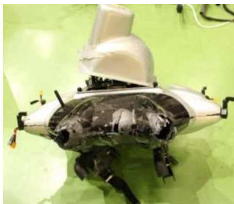
図 2.1.1.7-333 18m/s 衝撃試験後 写真 1（ドローン②）
