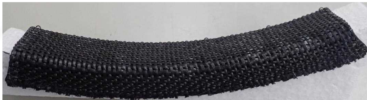
目標形状を模擬したニアネットシェイプでの三次元プリフォーム試作品
