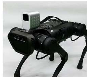
図 ガラス(透明物)を検出すロボットセンサー
