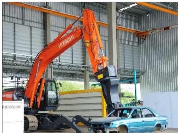
図9 ELV 事業導入技術（解体用重機）
