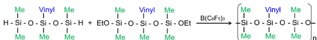
図②-2-2-3-13 ABA 型ポリシロキサン(A:-SiMe 2 O-, B:-SiMeViO-)の合成
