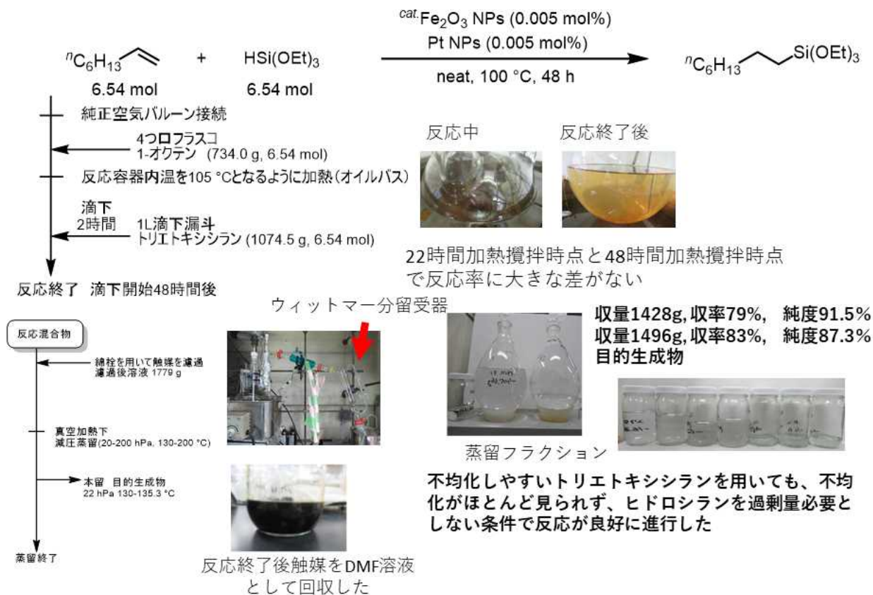
図②-1-1-7-31 トリエトキシシランを用いたキログラムスケールの実験
