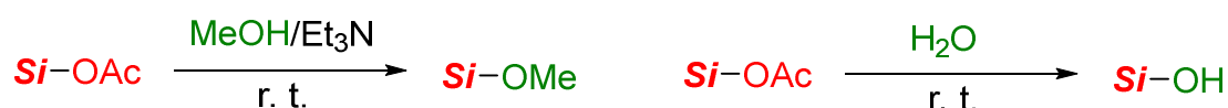
図②-2-2-2-14 アセトキシ体のメトキシ体またはシラノール体への変換
