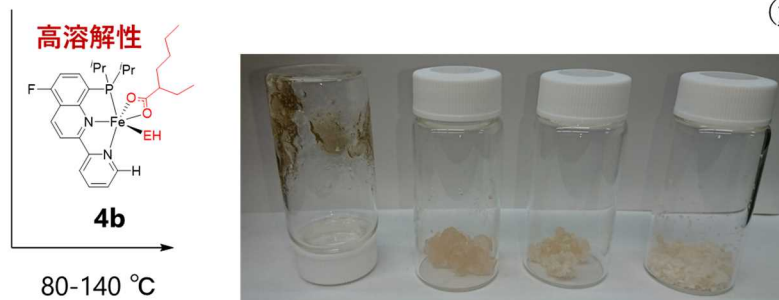
図②-1-1-6-17. 反応性シリコーンの硬化反応
