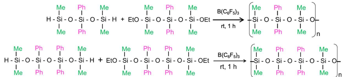
図②-2-2-3-10 (上段) ABA 型ポリシロキサン、 (下段) ABBA 型ポリシロキサン(A: -\text{Me}_2\text{SiO}- 、B: -\text{Ph}_2\text{SiO}- )の合成
