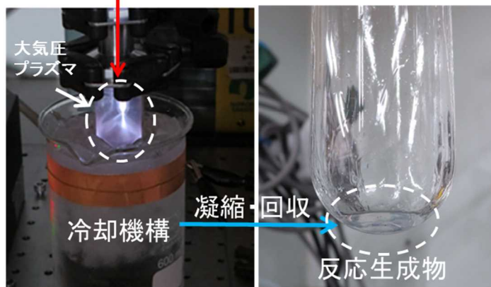
図①-5-2-2 大気圧プラズマ中への気化 TMOS 供給、反応、凝縮法
