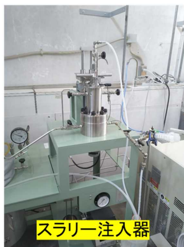
図①-1-25 1 kg スケール実証用 3 L スケール合成 CSTR 装置
