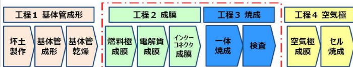
本事業範囲-成膜工程と焼成工程の最適化
