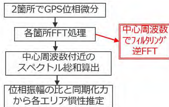
図 1 0 3 位相振幅の波形算出フロー
