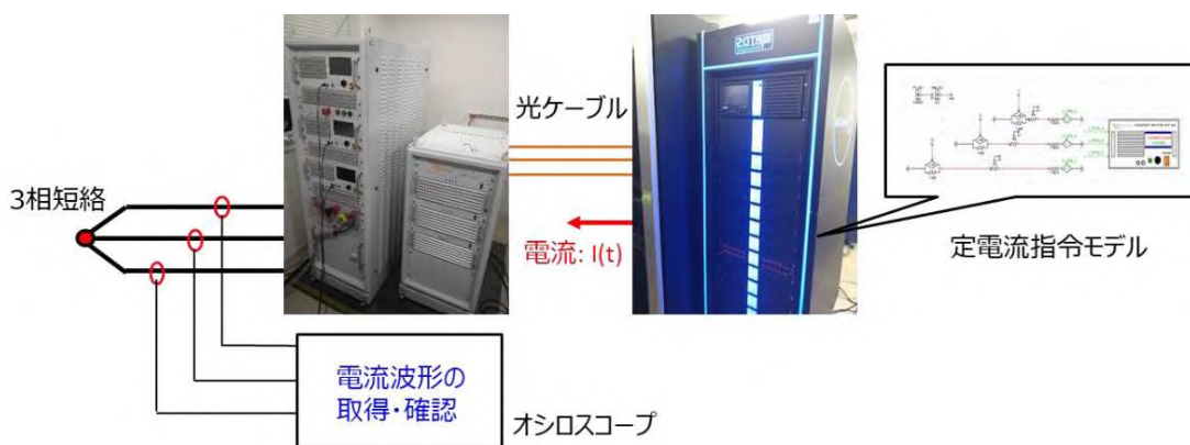
図 2 6 0 RTDS からのアンプへの電流指令検証の概要
