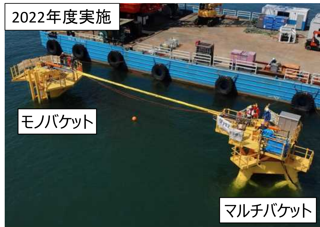
マルチバケットに対する水平載荷試験 9/15
