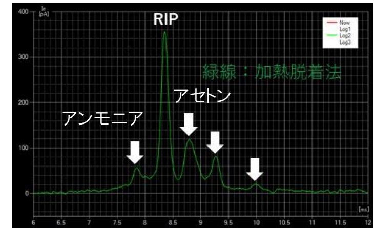
犬の呼気成分のIMSスペクトル (電子放出正イオン化、希釈法、加熱脱着法)
