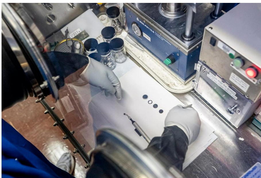
Muhammad Ihsan Ul Haq 氏は、クイックリリースバインダーを使用した材料のリサイクルに向けて、腕時計など多くの機器に使用されているコイン電池を準備している。研究チームのテストでは、同バインダーが幅広い種類の電池に対応できることが示されている。(写真提供:Marilyn Sargent/Berkeley Lab)
