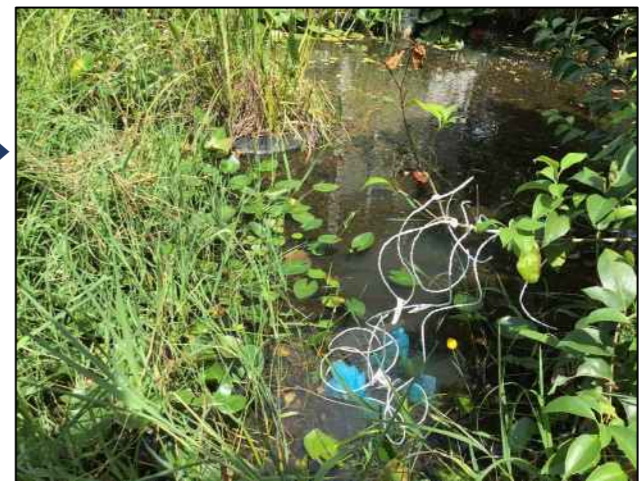
プラスチックネットに生分解性プラスチックを入れ、池に暴露
