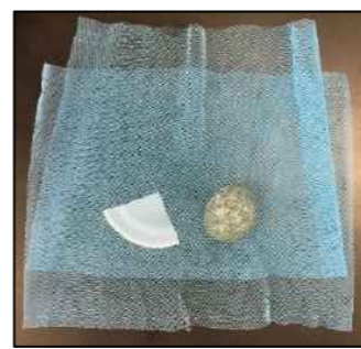
プラスチックネットに生分解性プラスチックを入れ、池に暴露
