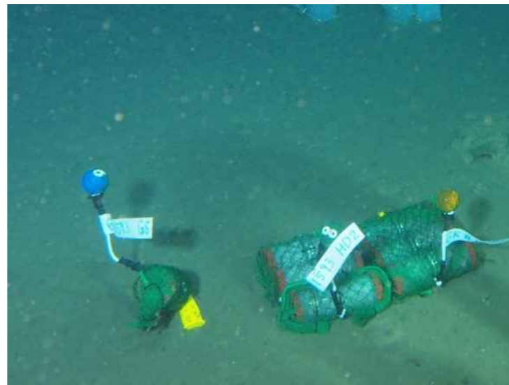
深海底に設置された新素材を含むチャンバー
