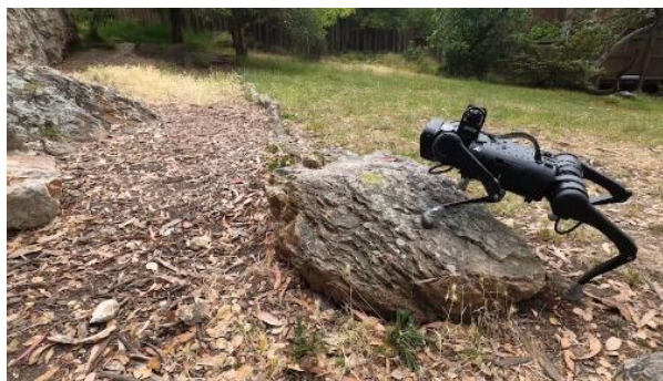
CMUとUCBが設計したロボティックシステムは、障害物の多い環境に対応する小型で低コストの四足歩行ロボットを実現する
