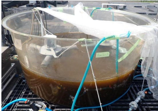
【図】2021年度ソリス 透明ポリカーボネート製培養装置
