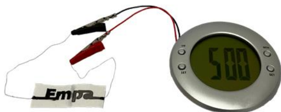
研究所の名称（『EMPA』）をステンシル印刷した紙バッテリー。LCD 目覚まし時計など、低消費電力電子機器を作動できる(画像: EMPA)
