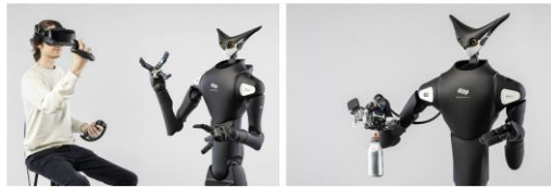
ローソン店舗にて遠隔操作ロボット、Model-Tによる商品陳列を開始 (Teleistence株式会社)
