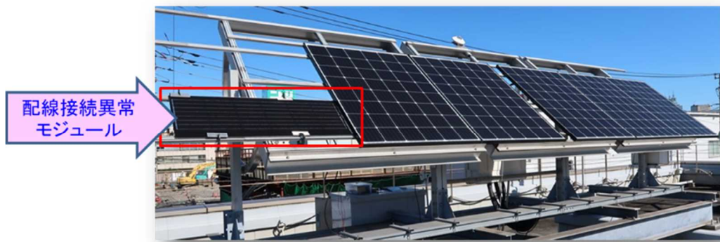
図Ⅲ-2-(ロ)-(i)-A-8 モジュールアーク発生再現試験（屋外試験）
