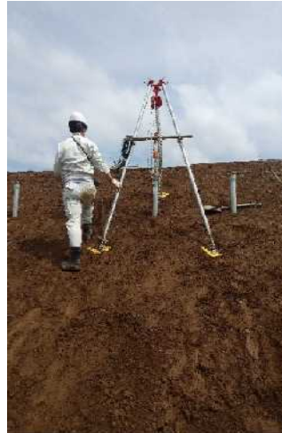
図Ⅲ-2-(ロ)-(i)-B-2 傾斜地における杭の荷重試験 (千葉県君津市)
