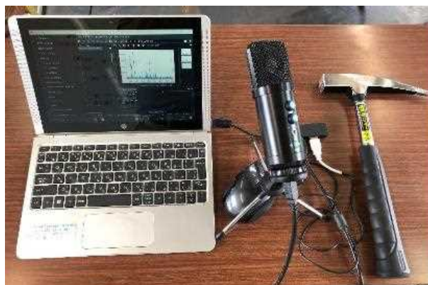
図Ⅲ-2-(ロ)-(i)-D-3 打音による支持力判定機材
