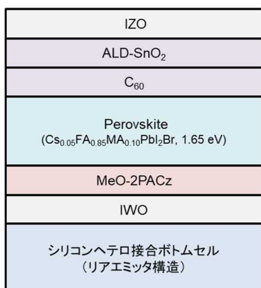
図 III-2-(イ)-(ii)-E-1 ペロブスカイト／結晶シリコンタンデム太陽電池の断面構造の模式図
