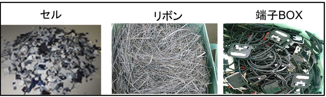
図Ⅲ-2-(ロ)-(ii)-A-13、リサイクル処理後のセル・リボン・端子BOX
