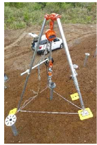
図Ⅲ-2-(ロ)-(i)-B-2 傾斜地における杭の荷重試験 (千葉県君津市)
