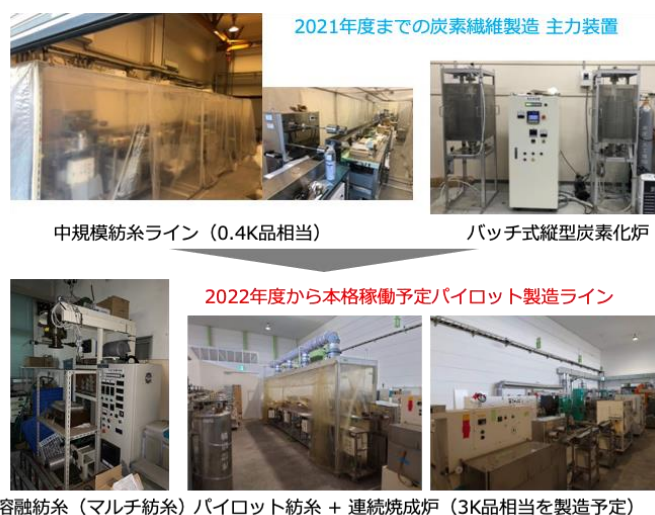
図 3 : パイロット炭素繊維製造ライン
