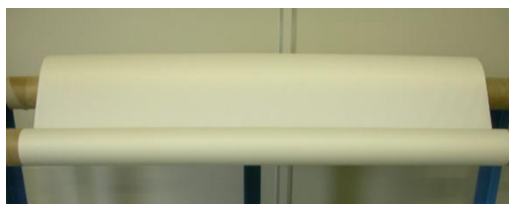
写真 2：製品巾 1 m の静電紡糸不織布
