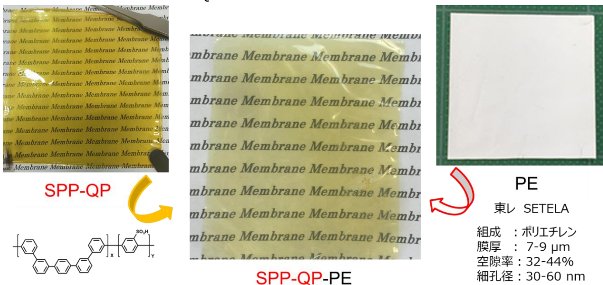
図7. 機械強度向上のための多孔基材による補強
