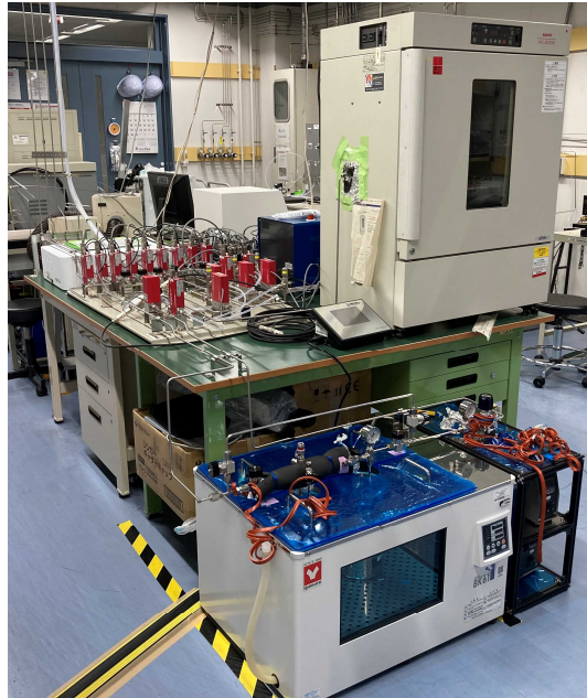
図 3.2.7.2.②-9 導入した蒸気発生ユニット（右下の装置が該当）、低濃度ガス生成装置（中央左のガス配管等一式が該当）、および、専用試料室（右上の装置が該当）
