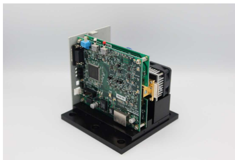
図6 モジュール光源 駆動回路の試作
