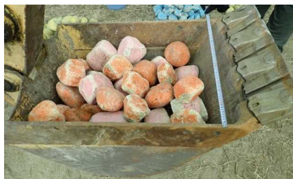
写真 3.2-3 バックホウ・バケット内の玉石の一例（直径 10~20cm）
