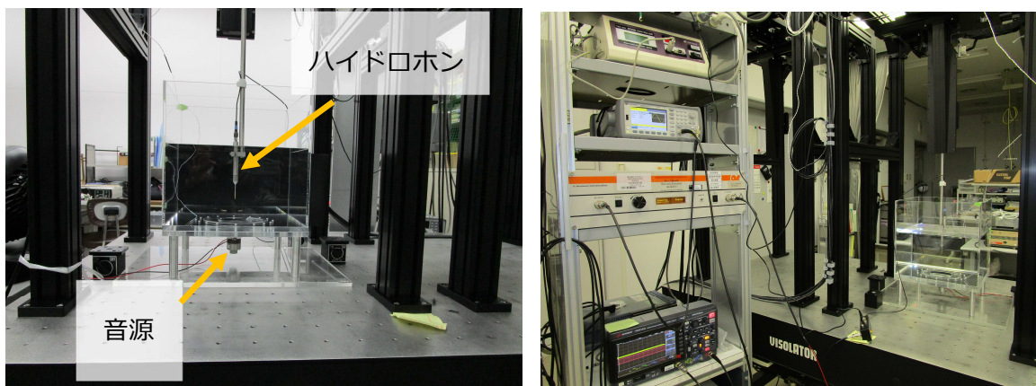
図 3.2.7.2.①-1 左:水槽内に設置された音源とハイドロホン、右:音波の送受信実験装置
