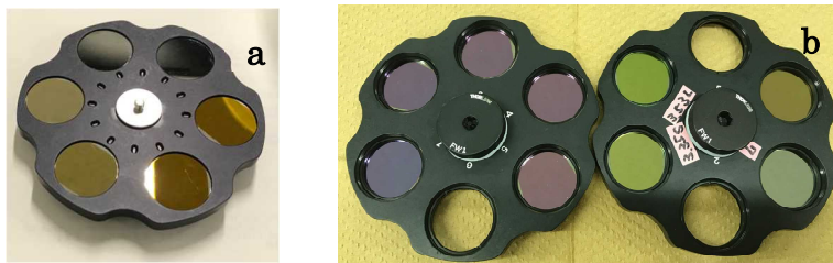
図①-1 開発した光学ファントム標準器
