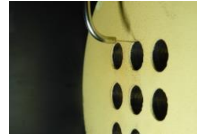
モデルバーナ気流試験 濃度分布計測
