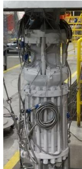
製作した小型試作機 (LNG試験後)
