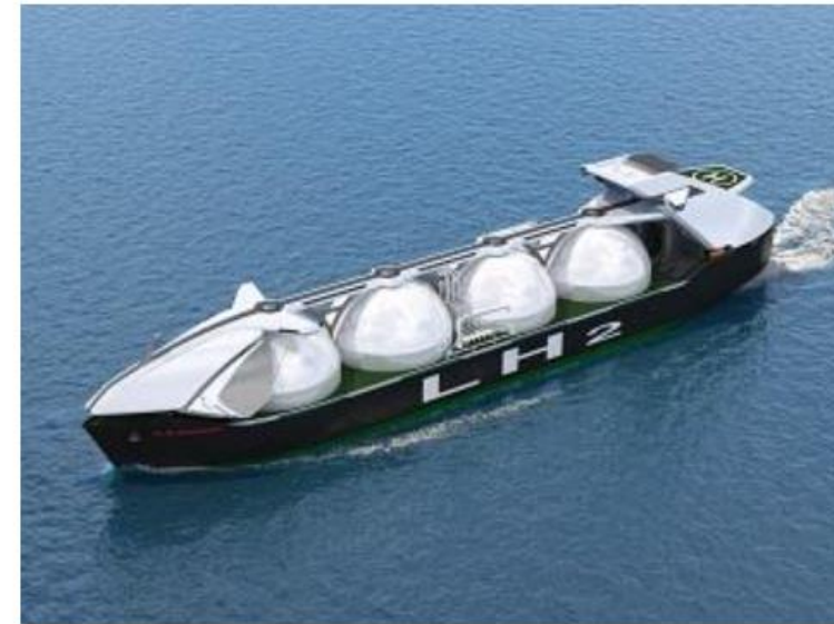
大型液化水素運搬船（貨物格納容積：40,000m 3 ×4基 搭載イメージ）
