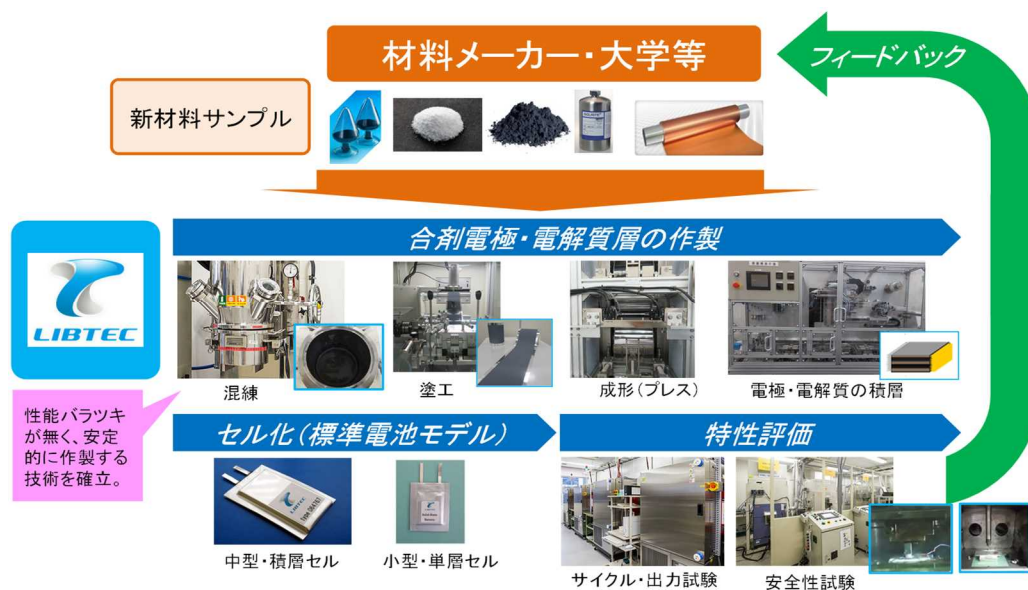
図 2.2.1-4 標準電池モデルを用いた新材料の特性評価の流れ
