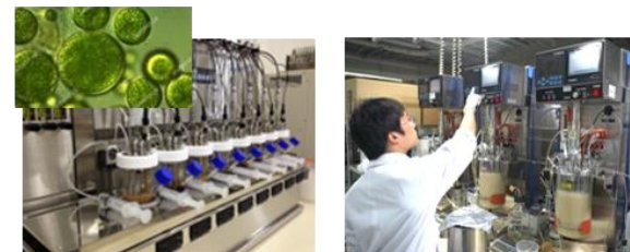
スマセル培養多次元データの収集・機械学習 (温度、pH、培地組成、通気など)
