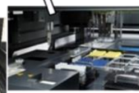
12連自動培養槽 pH/溶存酸素濃度/温度を自動制御 培養液採取/代謝反応停止ロボット 代謝物抽出ロボット メタボローム解析自動前処理ロボット
