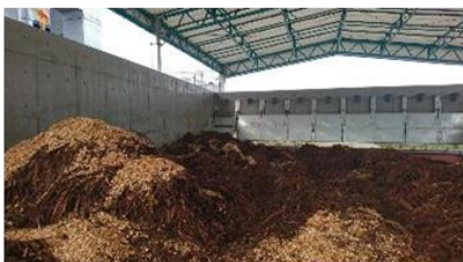
原料投入ウォーキングフロア
