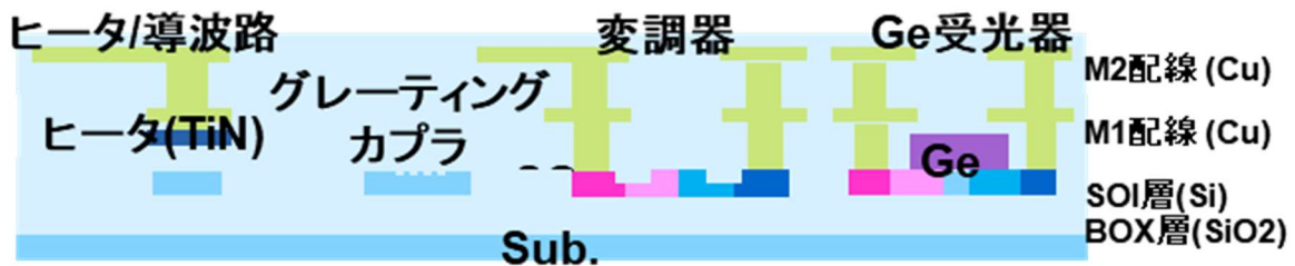
図 1.2.2.1(イ)-8 ファンドリにおいて試作した光集積回路の断面構造
