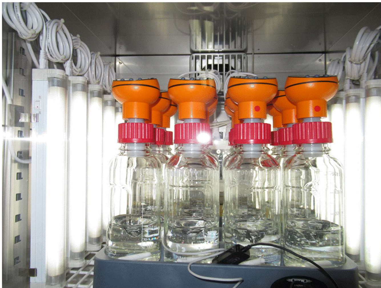
光照射型海水生分解測定装置
