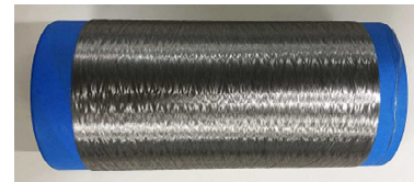
実用化プラントにて紡糸したCNT複合溶剤法セルロース繊維の管糸
