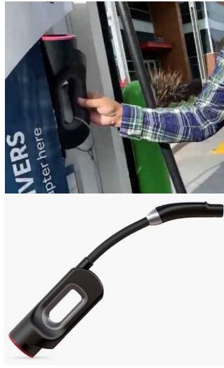
Tesla CHAdeMO Adapter ($400, 50kW充電に対応)
