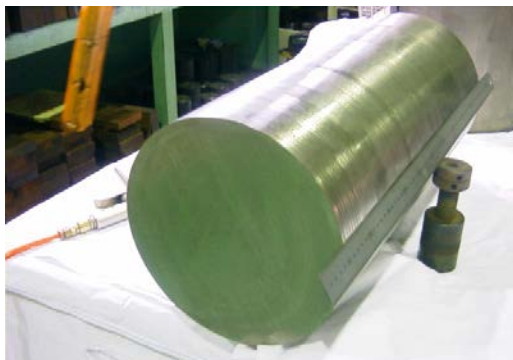
図 4.5-9 開発 TiAl 合金の大型 インゴット (φ 300mm×500mm、 145kg)
