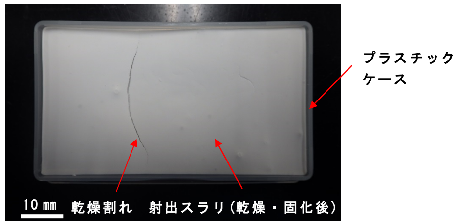
図 4.4-8 新規射出用スラリーの乾燥後外観
