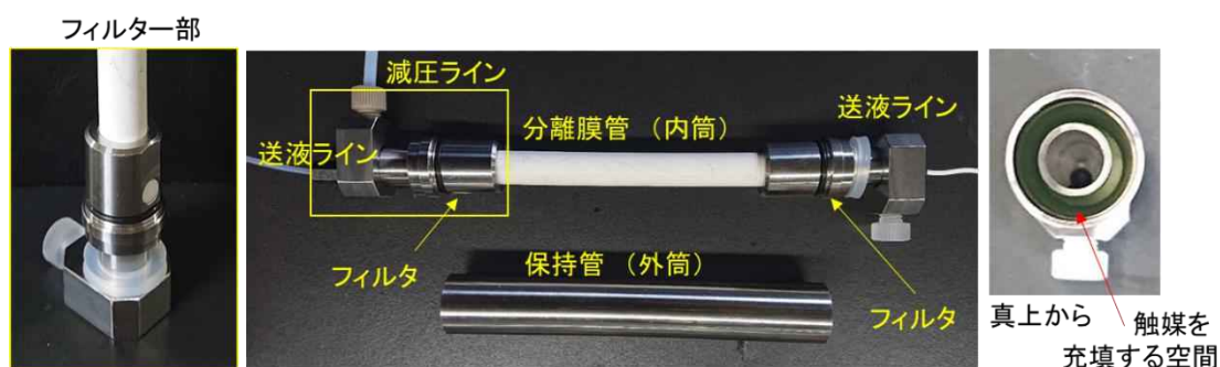
図 3.2.1.2-63 試作した小型反応分離用フロー反応器
