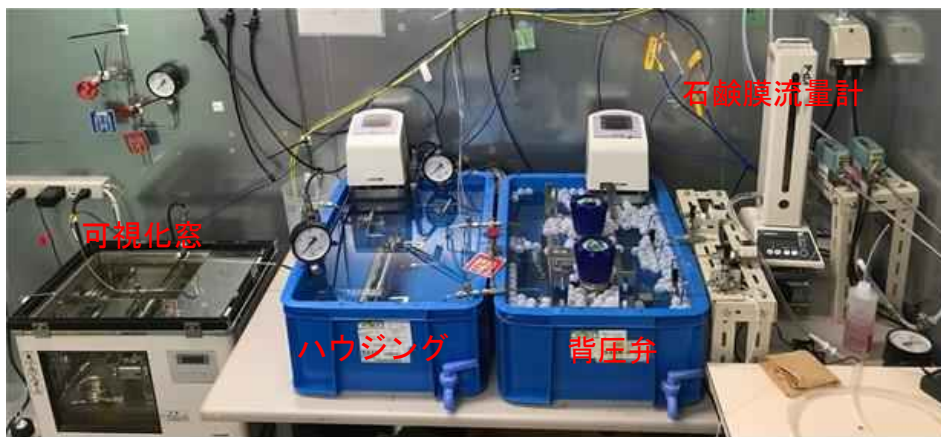
図 3.2.2.1-72 高圧 CO 2 膜透過・溶液濃縮試験装置の外観
