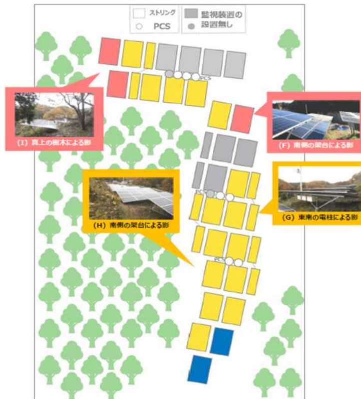
図7 スtring IoT の予備検討結果。(低圧：50kW) PV 発電所でのデータ。
