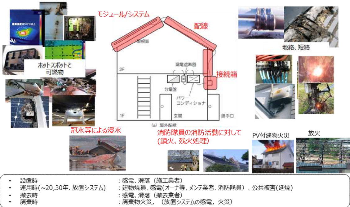
図7 太陽光発電システムの直流電気安全に関するハザード
