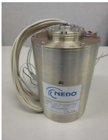
図 サブサイズモデル高耐熱評価用電動機
