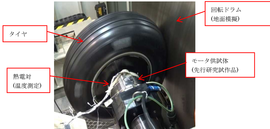
図 走行模擬試験実施状況
