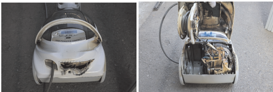
図 2.2.1.3.2-2 発煙した電気掃除機の様子
