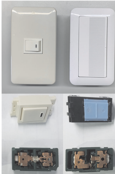
図 2.2.1.2.2.4-1 供試照明スイッチの外観写真。上段：スイッチ筐体，中下段：接点部 左列：Type A，右列：Type B
