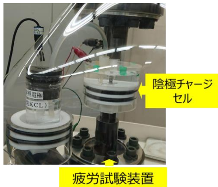
図8 連続陰極充電疲労試験機の外観
