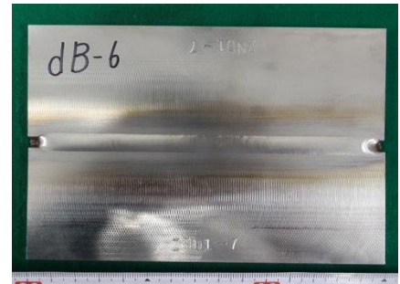
図 24 作製した溶接材 (溶接継手) 外観
