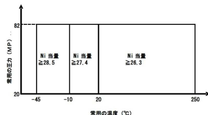
図 常用の圧力及び常用の温度と必要とされるニッケル当量の関係
