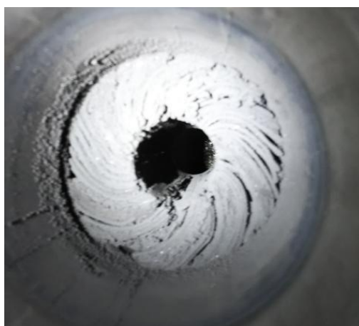
図 5 触媒筒に固着した生成炭素
