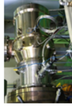
着火試験装置 (左) 水素着火時の燃焼状態 (右)
