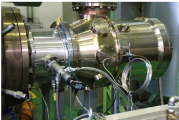
図 11. 着火試験装置と試作燃焼器
