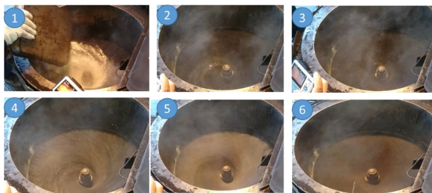
図3-7 試験機による混練状況
