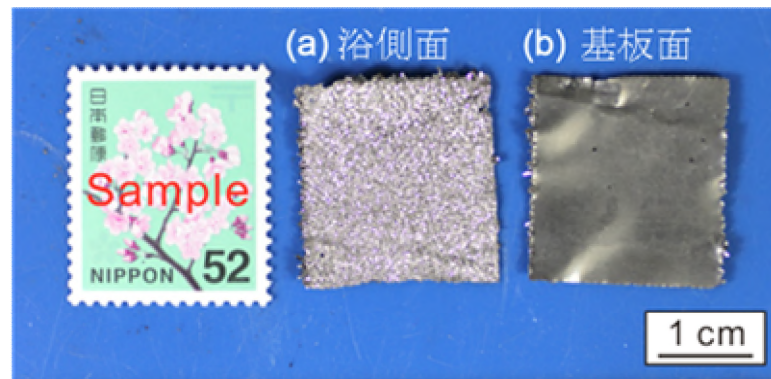
図Ⅲ-2.4.2-6 電析によって得られたチタン
