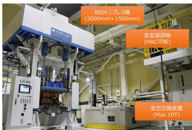
図Ⅲ-2.6.1-13 800 トンプレス機システムの構築
