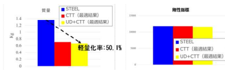
トポロジー最適化による接合面の変更
