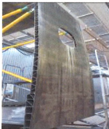
図Ⅲ-2.3.5-4 モックアップ構体へのシャワー型化成処理後外観
