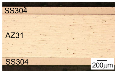
図Ⅲ-2.1.4-4 鋼／Mg 合金の複層化
