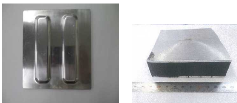
図III-2.6.2-17 アルミ/CFRTP一体成形品
