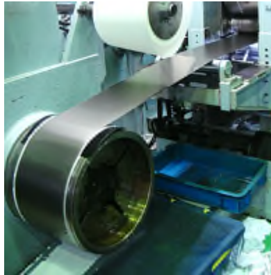
図Ⅲ-2.4.2-5 冷間圧延の状況
