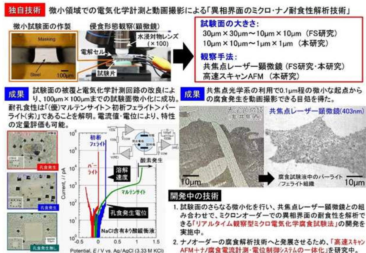
図III-2.1.6-1 微小領域電気化学計測技術と炭素鋼の腐食起点解析への適用例
