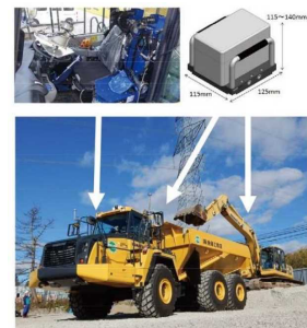
後付けて既存建機を自動化
