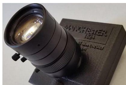
SCAMP-5d 視覚情報処理システム 画像クレジット: The University of Manchester, 2020.
