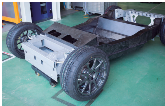
自動車などのモビリティ向けの構造材料の軽量化に向けて、製作に成功した世界初のオール熱可塑性 CFRP の自動車用シャーシ 提供：新構造材料技術研究組合(ISMA)
