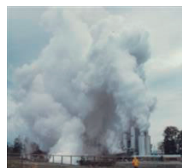
図28 ● 「地熱探査技術等検証調査」の成果(秋田県澄川地域での長期噴出試験、蒸気流量 194t/hを記録)
