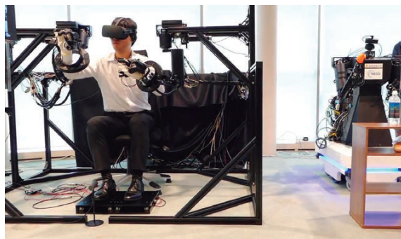
人間の代替となるロボット操作の実現に向けて開発された、高精度力触覚技術を搭載する双腕型ロボット
