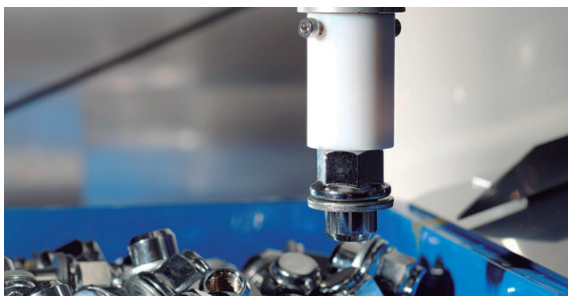
「イノベーション実用化ベンチャー支援事業」で成果を出した3次元ビジョンセンサー。産業ロボットに見て考える機能を付加し部品供給の自動化を実現。第13回産学官連携功労者表彰において、経済産業大臣賞を受賞
