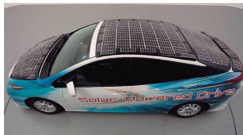
狭い面積でも十分な発電量が 得られる車載用太陽電池
