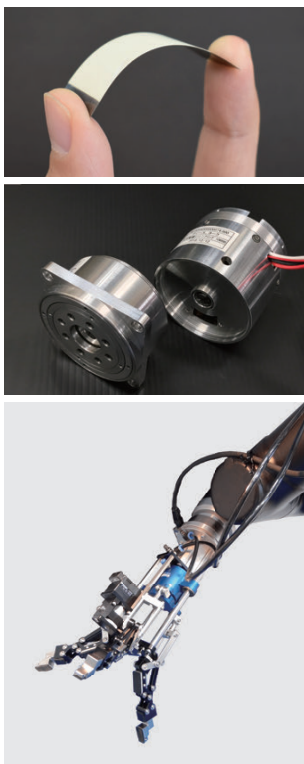
図2 ● 皮膚センサー(上)、小型・高効率・高出力なアクチュエーター(中央)、3本指ロボットハンド(下)
