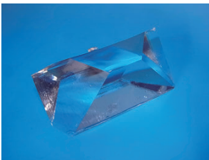
図5 ● 高品質結晶化技術で作られたホウ酸系非線形光学結晶
