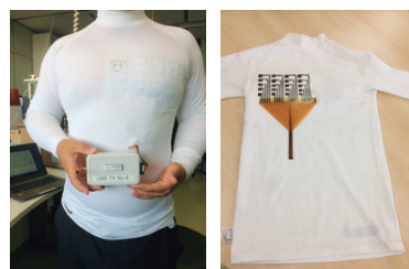
図7 ● センシングウェアのイメージ (テキスタイルに印刷した配線 (右))
