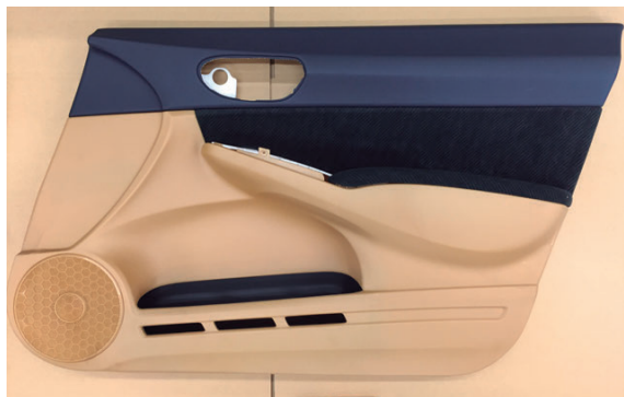
「非可食性植物由来化学品製造プロセス技術開発」では、CNF強化樹脂の実用化に向けドアトリム(ドアの内張り)の試作などを実施 提供: ティ・エス・テック
