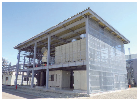
CO 2 を有効利用する「カーボンリサイクル」の技術開発が活発化。CO 2 を原料にメタンを合成するメタネーションの試験を新潟県長岡市で開始 提供：国際石油開発帝石 長岡鉱場
