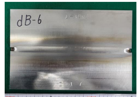
図 24 作製した溶接材 (溶接継手) 外観
