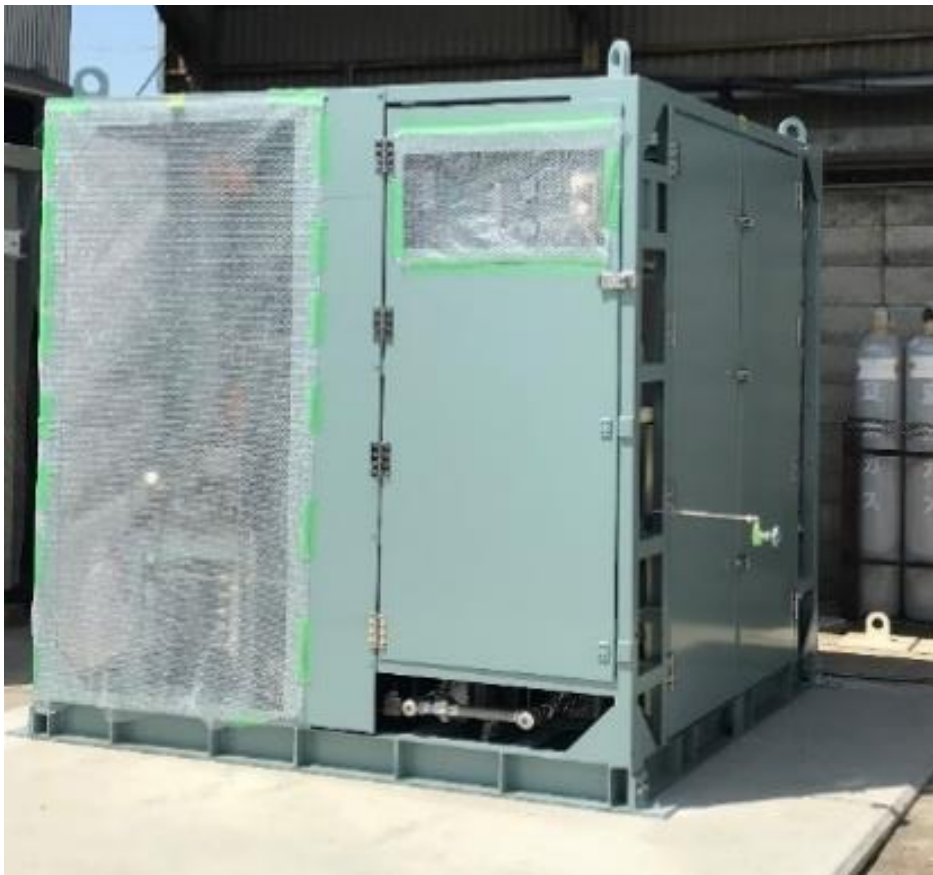
図 5 加地テック開発の 2.2Nm 3 /h×20MPa 水素ポンプユニット (装置 No.KTC-A)
