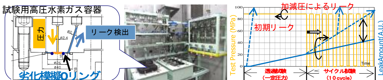
図11 Oリングシール性能評価設備と透過曲線概念図
