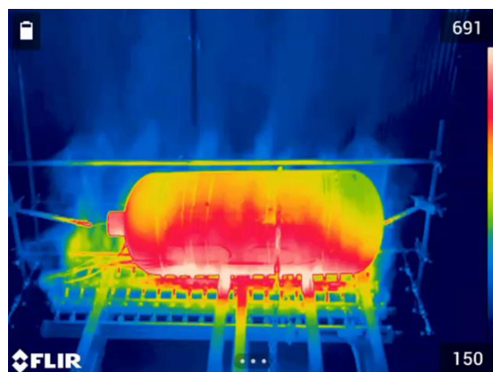
図 10 基準バーナによる赤外線熱画像による容器温度
