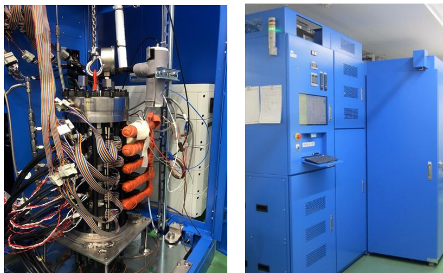
図 1 東レ開発の 5Nm 3 /h×40MPa 水素ポンプスタックおよび評価設備
