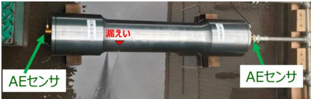
図16 鋼製小型蓄圧器の疲労き裂進展試験の状況
