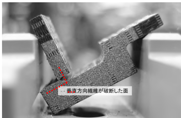
図 7.2.2.2-7 疲労試験後の試験片外観
