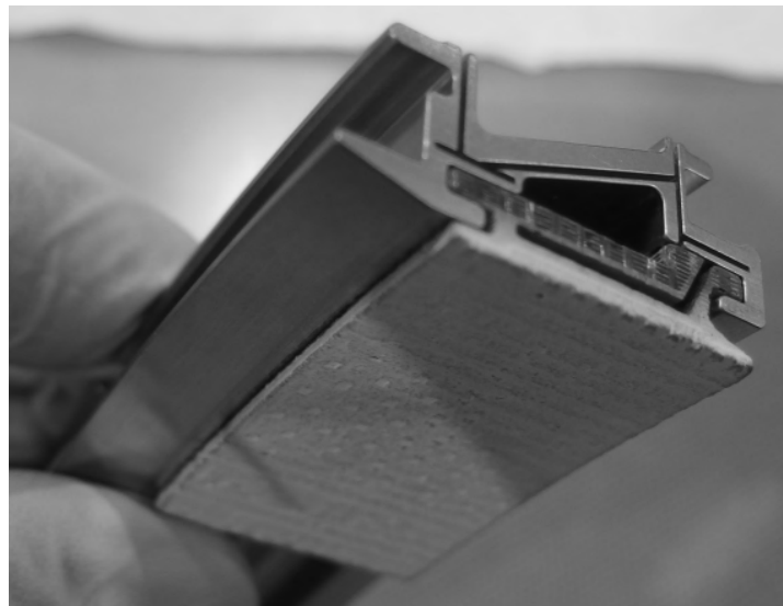
図 7.2.2.2.1-2 CMCシュラウド部品をエンジン部品(シュラウドサポート)に組付けた際の外観
