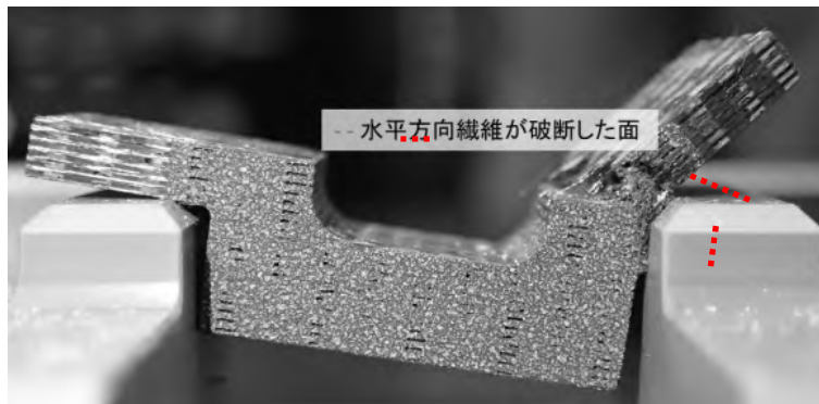
図 7.2.2.2.2-6 静的試験後の試験片外観
