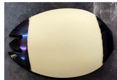
スプーンへの 圧電膜塗布結果
