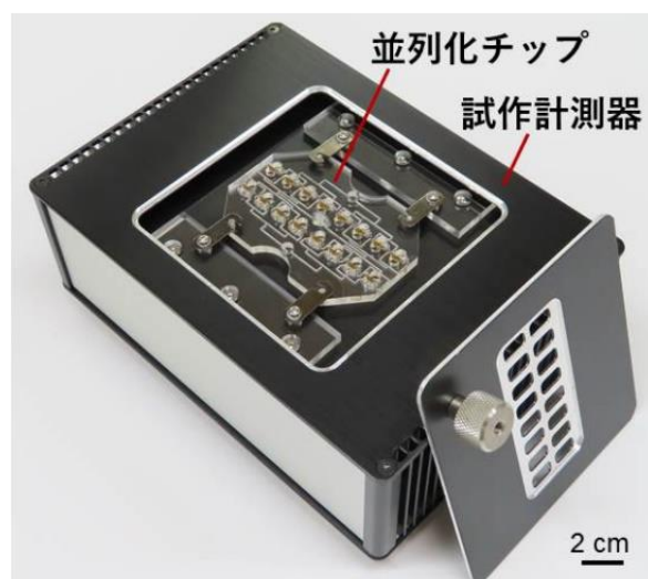
16個のアレイ化センサチップを搭載可能な小型計測器
