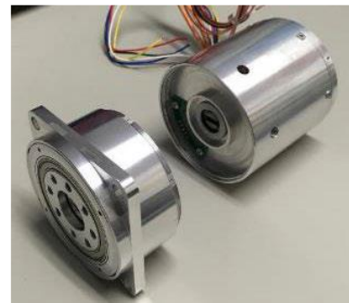
減速機・モーター一体型 アクチュエータシステム
