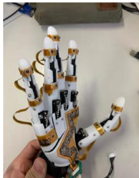
集積化センサ 20 個を実装した 人型ロボットハンド
