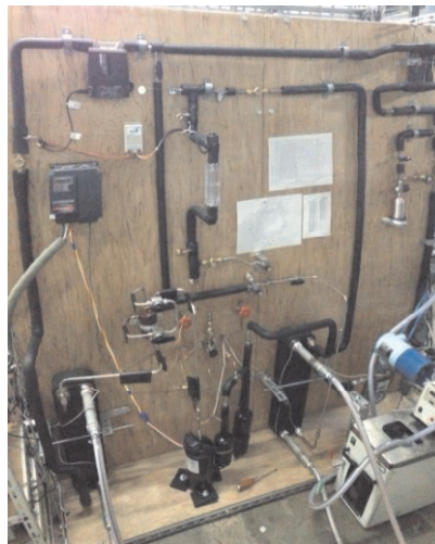
図 1-3-2.3 膨張弁の制御特性評価実験のための実験装置のフロー図
