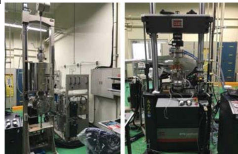
水蒸気環境中クリープ試験機、水蒸気環境中疲労試験機
