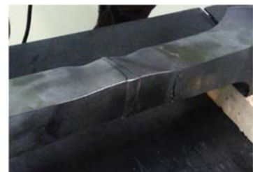
損傷した短冊一軸クリープ試験体
