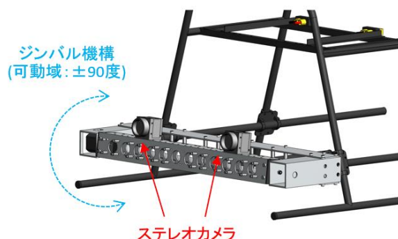
図Ⅲ2.2.2.1-12 カメラジンバル CAD 図とその可動範囲
