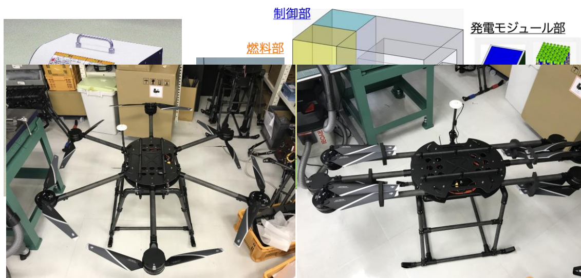
図Ⅲ.1.2-13 コンパクトハイパワー燃料電池システムの外観と構成
