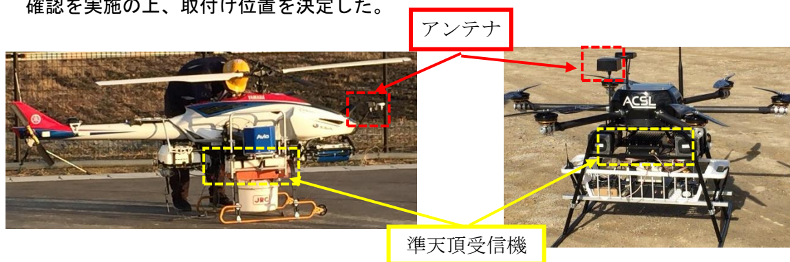
図Ⅲ2.2.1.3-13 準天頂衛星対応受信機のドローンへの搭載
