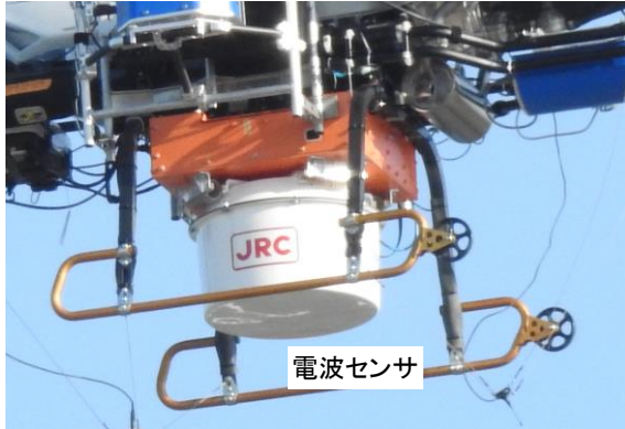
図Ⅲ2.2.1.3-7 探知機への電波センサの搭載状況
