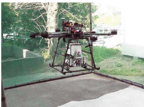
飛行試験中の固体酸化物形燃料電池ドローンとsofcシステムおよびスタック
