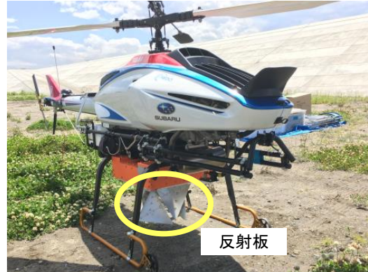
図Ⅲ2.2.1.3-8 脅威機に取り付けた反射板
