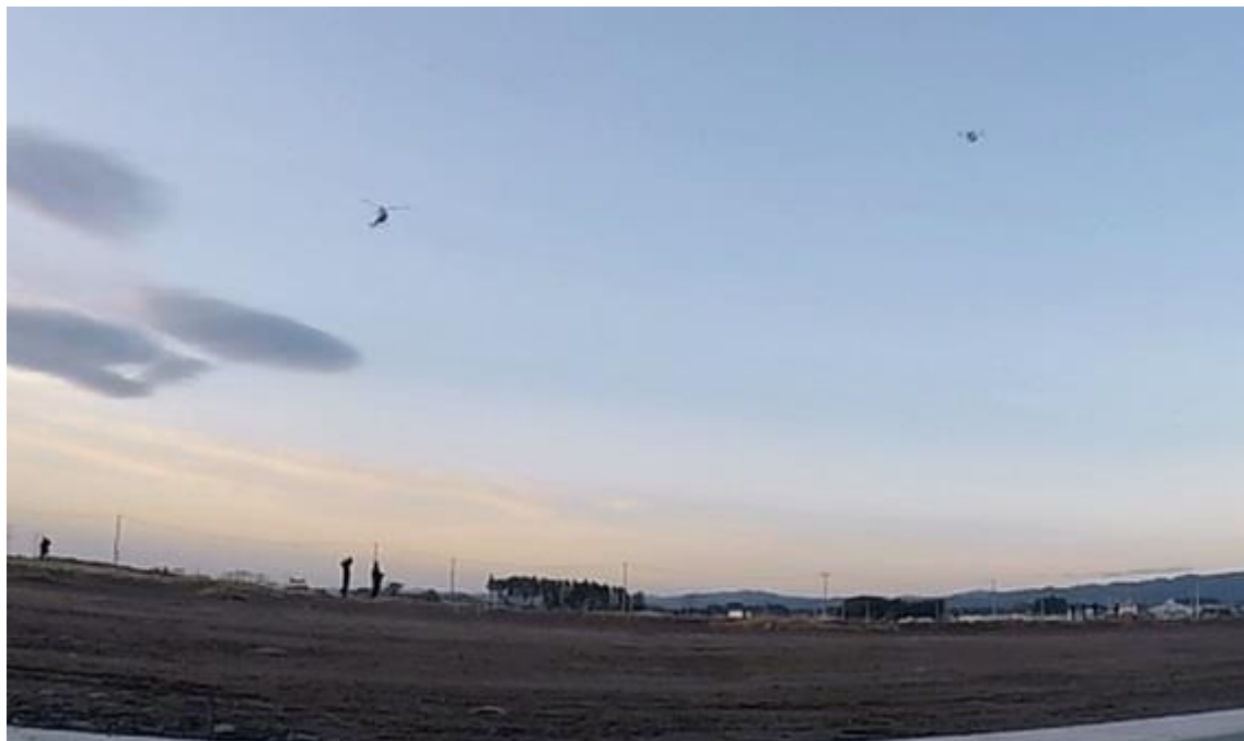
図Ⅲ2.1.1.4-7 ダウンウォッシュ影響確認試験－前進飛行試験実施状況
