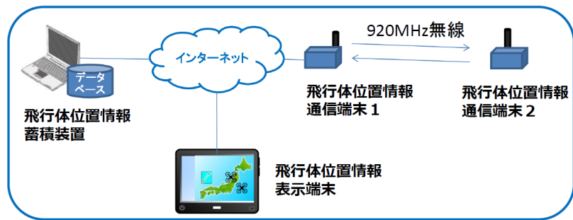
図Ⅲ2.2.1.2-6 移動体端末間の直接通信によるドローン位置情報のUTMへの集約
