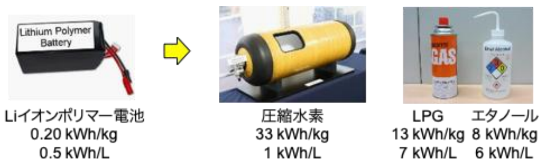
図Ⅲ2.1.2-7 二次電池・燃料のエネルギー密度
