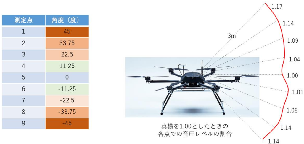
図Ⅲ 2. 1. 1. 1-8 音圧を測定した点とそれぞれの点での音圧レベルの比較
