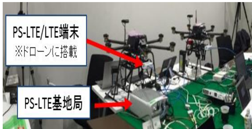
図Ⅲ2.2.1.1-11 PS-LTE/LTE マルチ接続通信環境
