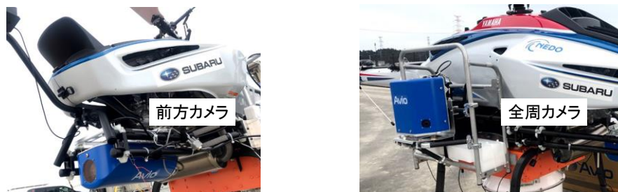
図Ⅲ2.2.1.3-10 探知機への光波センサの搭載状況
